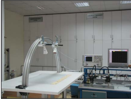
Şekil 7. TÜBİTAK MAM ME MİLTAL'daki yay metodu ile malzeme karakterizasyon ölçüm düzeneği.
